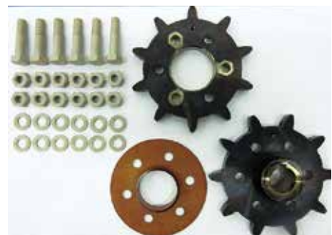
交互欠歯車締結用特殊樹脂ボルト （機械工学科 東崎研究室）
