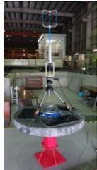
図 2. 乱流計測ブイシステム
