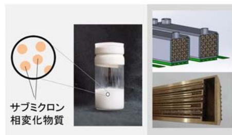
相変化エマルジョン(左)および3Dプリンタにて作製されたヒートシンク(右)
