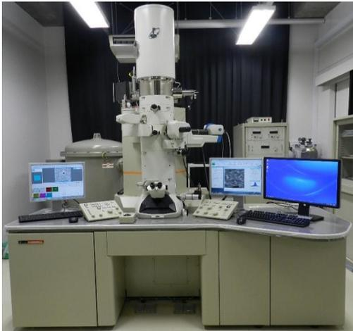
本装置は、これまで導入されていたTEMの老朽化に伴い更新された装置で、200 kVの加速電圧でも高分解能観察が可能な高性能TEMです。二種類の撮影カメラと極微箇所への電子線照射を可能とする絞りを有しており、制限視野電子線回折像の取得も容易です。また、エネルギー分散型X線分析装置による分析も可能で、一般的なEDXスペクトルだけでなく元素マッピングや線分析も可能となっています。さらに、STEM(走査透過型電子顕微鏡)観察も可能であり、高角度散乱暗視野STEM(HAADF-STEM)観察による像の撮影も可能です。
