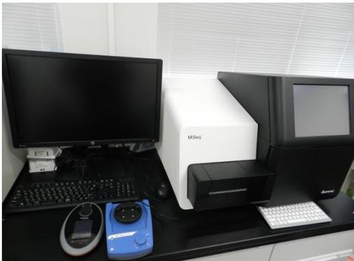
この度、次世代シーケンサー(イルミナ社MiSeq)、バイオアナライザー(アジレント社2100)および解析ソフト(フィルジェン社 GLC Genomics Workbench)を組み合わせたゲノム・遺伝子解析システムが共同利用センターに設置されました。1ランで最大15Gbの塩基配列データを出力可能な本システムを使用することにより、トランスクリプトーム解析、遺伝子発現プロファイル解析、未知転写産物の探索、ターゲットリシーケンシング、多サンプルアンプリコンシーケンス、16S rRNAメタゲノム解析など、超高速かつ大量の配列解析が低コストで行えます。さらに、イルミナ社製の癌・自閉症・心筋症等のサンプル調整キットを使用した各種疾患関連遺伝子群の変異解析や、MiSeq互換のサードパーティー製のサンプル調整キットも各メーカーから発売されており、多様なアプリケーションが利用できます。サンプル調整以降は全自動であり、手軽で低コストな網羅的解析手段として皆様方のご利用を期待しています。
