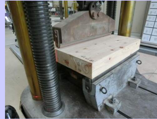
パネルのせん断試験
