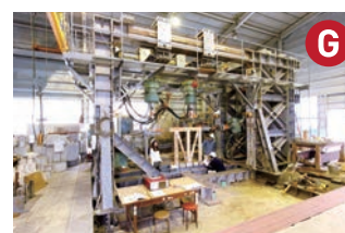
建築構造実験室 実際の建物と同じ鉄筋を組み上げ、縦横に強い力を加えて、壊れ方を観察・分析することができます。
