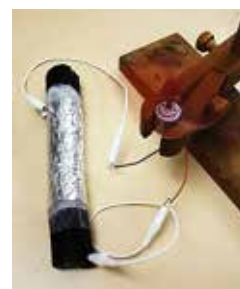
備長炭とアルミホイルを利用した空気電池の原理の実演の様子
