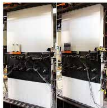
RC制振方立て壁加力実験状況
