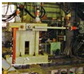
有開口耐震壁の実験状況
