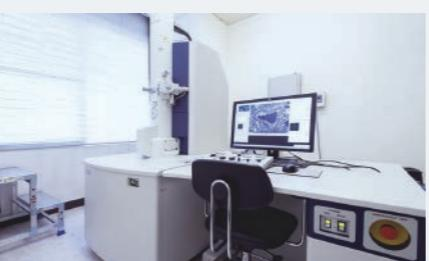
透過電子顕微鏡、走査電子顕微鏡を備え、臓器の細胞内小器官や表面の細胞立体像をミクロ、ナノレベルで観察・分析可能。
