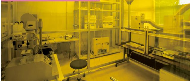
2024年2月完成。紫外線の感光を防ぐための黄色のフィルターで覆われた簡易なイエロークリーンブースやフォトリソグラフィ装置などを完備しています。
