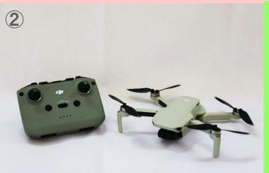
ドローン②の機体重量は199 gで、コンパクトで使いやすく、一般的に空撮で使用されます。
