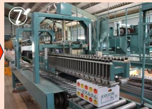
投入口に入れられたミカンはエスカレーターによって、選果台へと運ばれ厳格に選果が行われます(写真①～③)。選果したミカンは柔らかいフラシでひとつひとつ表面を綺麗に磨き(写真④)、大きさを判定するセンサーのトンネルへと入ります(写真⑤)。計量したのち、箱詰めを行い(写真⑥)、自動封かん機をとおり皆様のお手元へ届けています(写真⑦)。
