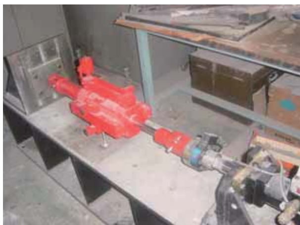
写真1 ダブルバイパス式MRダンパー (上: ストローク \pm 20\text{mm} 下: \pm 100\text{mm} )
