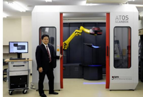
図1 デジタル画像計測ロボットシステム
