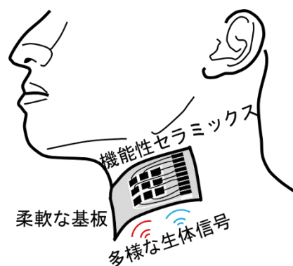
図2 目標とする「真に病気を未然に防ぐヘルスケアモニタ」。皮膚表面に違和感なく貼り付けることができ、24時間いつでもどこでも生体信号を取得できる。健康な状態から病気の兆候を示す状態への変化を見逃さないセンサを実現する。
