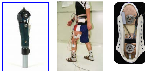
図1. インテリジェント大腿義足及びウェアラブルセンサシステム
