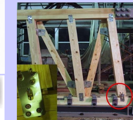
木造壁ブレースの実験
