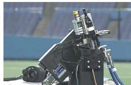
▲自動追尾・レーザー照射装置
