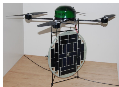
▲今回のヘリコプター(上から見た直径約1m、重さ約1kg、モーター4基)
