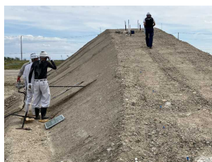
実物大盛土試験と電気探査による電気比抵抗分布
