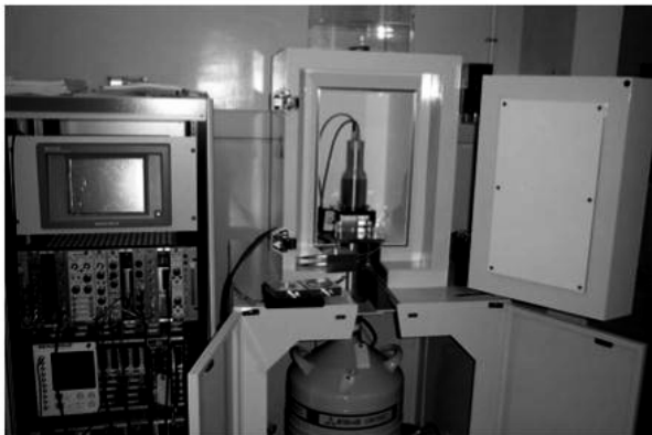
産総研の高純度ゲルマニウム半導体検出器とその計測システム
